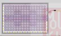
将插好的短电线灯带沿着盒子<mark>底座的最外</mark> 圈按照图示位置绕半圈贴上,灯珠的用途 请看第40步骤。
