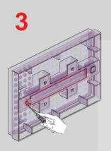
安装好电池后,将电池外壳 放回原位,旋紧螺丝。
