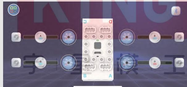
右上角图标显示蓝色蓝牙即连接成功, 模块指示灯长亮
