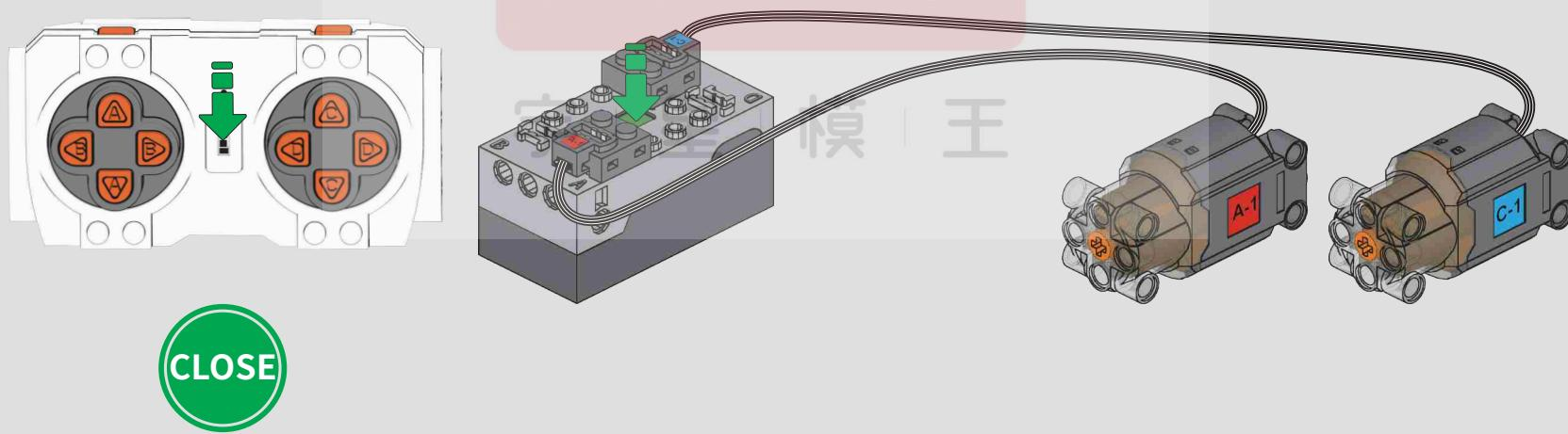
遥控器可更改电机旋转方向
