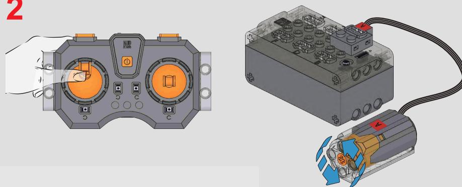
取出一个A电机, 连接模块A接口, 遥控器左摇杆向上移动, 电机动力孔向左旋转
