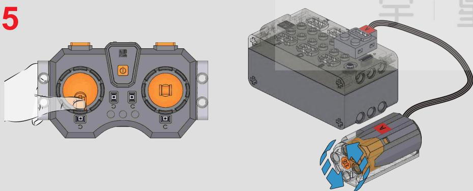
遥控器左摇杆向下移动, 电机动力孔向左旋转
