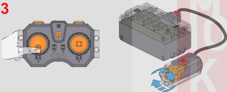
遥控器左摇杆向下移动, 电机动力孔向右旋转
